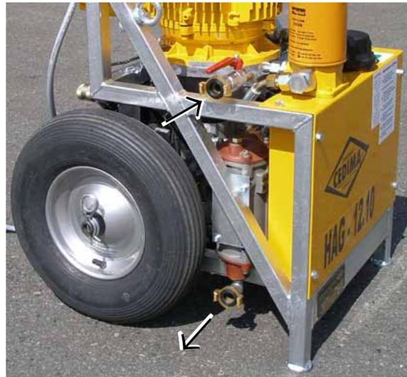
Bild 3.48 Wasseranschluß am HAG•12.10, Zulauf, Ablauf
