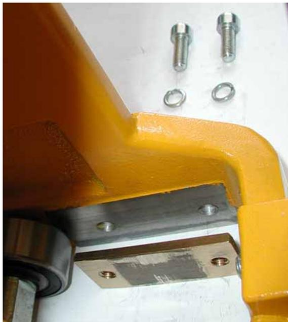
Bild 7.10 Untere Gleitplatte demontiert
