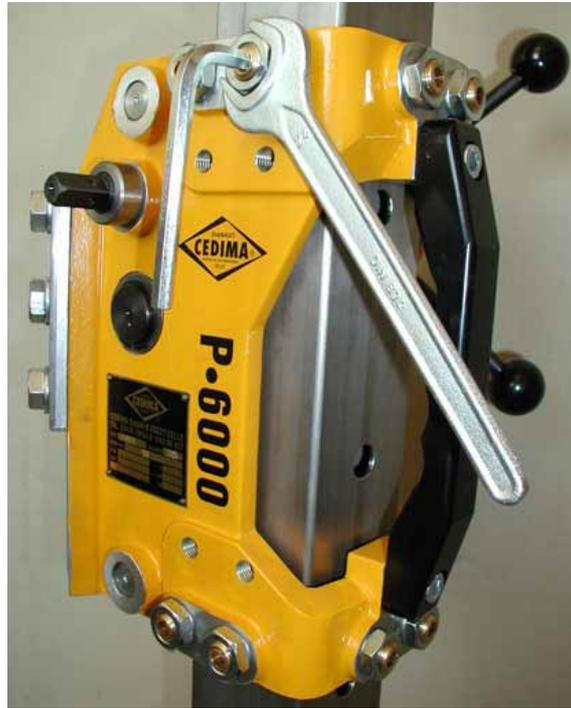
Bild 7.3 Gleitführungen, Messing-Stellschrauben einstellen
