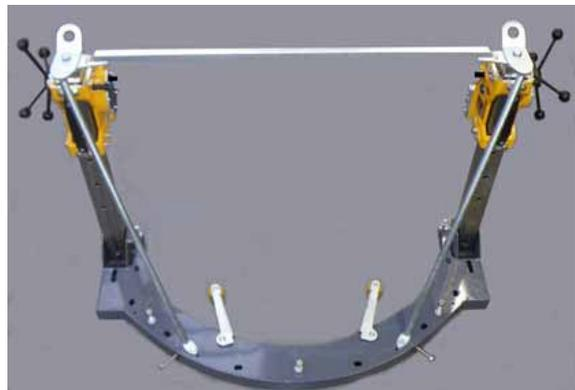
Bild 3.12 Führungsschlitten in der oberen Rastung festgesetzt
