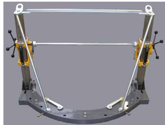
Bild 3.17 Vorschub-Verbindungswelle montiert
