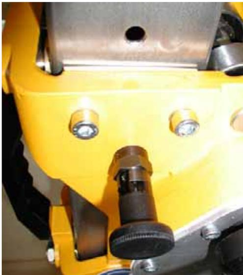
Bild 3.6 Rastbolzen außer Funktion, gezogen und arretiert
