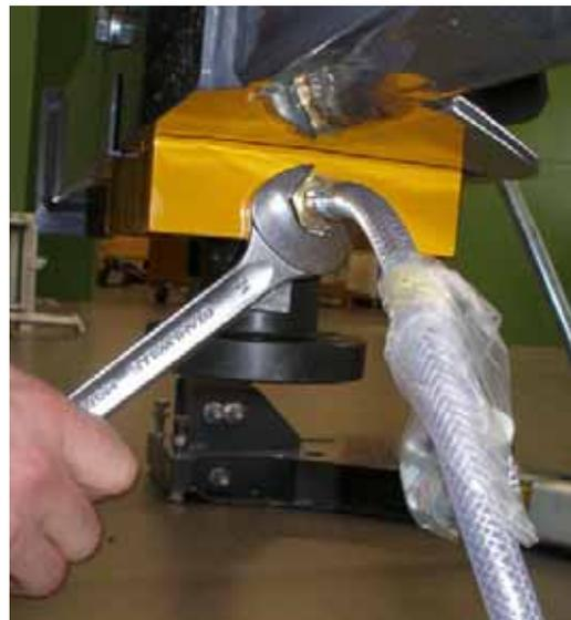
Bild 3.29 Wasserschlauch an die BSP•4 montieren
