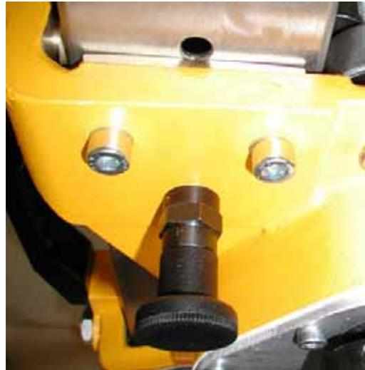
Bild 3.7 Rastbolzen in Bohrsäule eingerastet, Führungsschlitten festgesetzt
