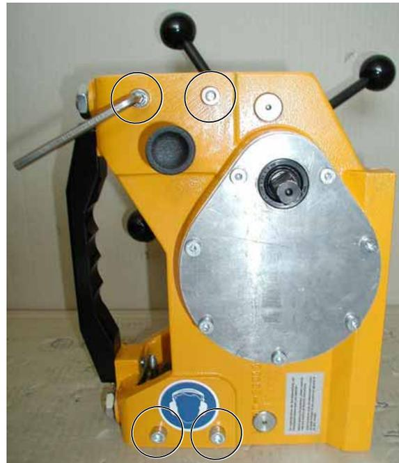
Bild 7.9 Schrauben der Gleitplatten
