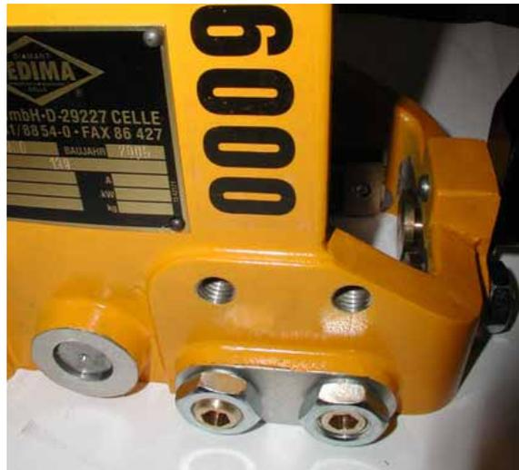
Bild 7.4 Gleitführungen, Messing-Stellschrauben unten am Führungsschlitten. Rechts Verschleißgrenze erreicht
