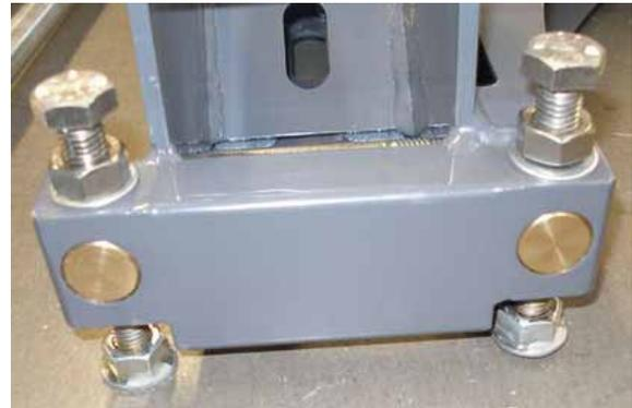
Bild 3.33 Justierschrauben vorn, links am Dübelfuß
