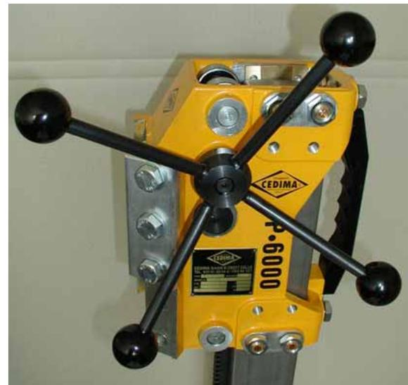
Bild 7.1 Führungsschlitten über die Bohrsäulen-Zahnstange hinaus fahren
