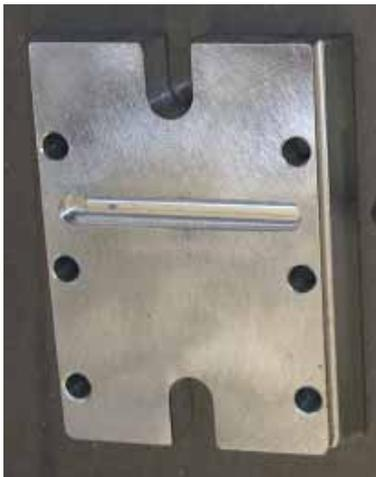
Bild 3.19 Anbauplatte für Bohrtraverse
