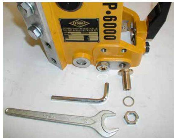
Bild 7.6 Gleitführung, Messing-Stellschraube, Paßscheibe, Sicherungsmutter demontiert
