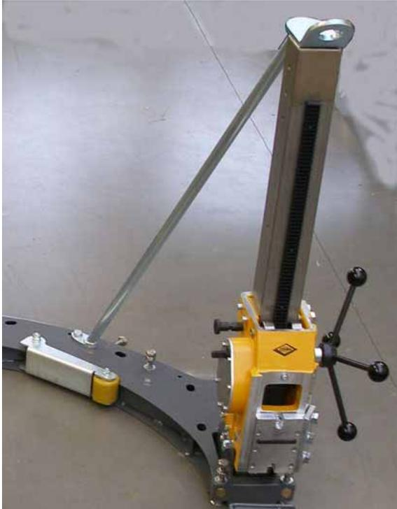
Bild 3.8 Rechte Bohrsäulen-Stütze an Dübelfuß montiert
