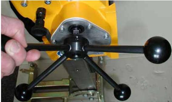
Bild 3.5 Drehkreuz am Führungsschlitten abziehen bzw. aufstecken
