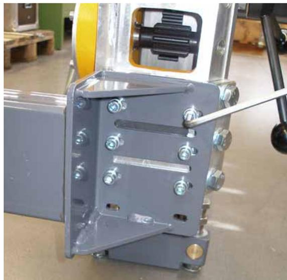
Bild 3.22 Bohrtraverse montieren, rechte Seite
