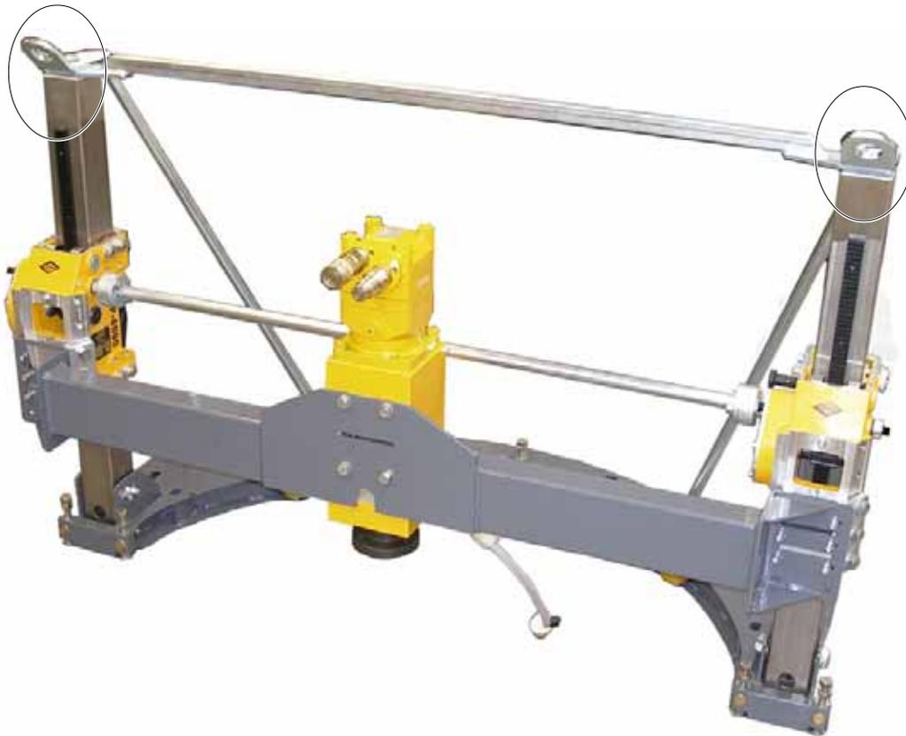
Bild 5.1 Kranösen zum Transport der montierten P•12500, Drehkreuze abgezogen
