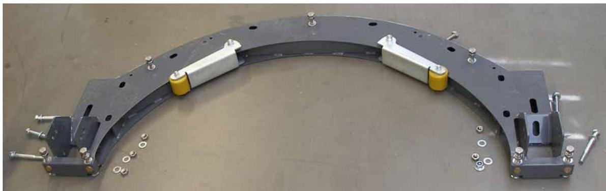
Bild 3.1 P•12500 -Dübelfuß mit Schrauben, Unterlegscheiben und Muttern der Bohrsäulenaufnahmen
