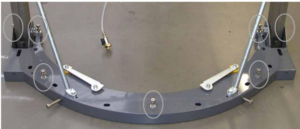
Bild 3.32 Justierschrauben am Dübelfuß
