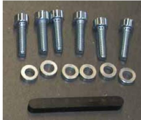
Bild 3.21 Verbindungselemente einer Bohrtraversen-Seite, zur Anbauplatte
