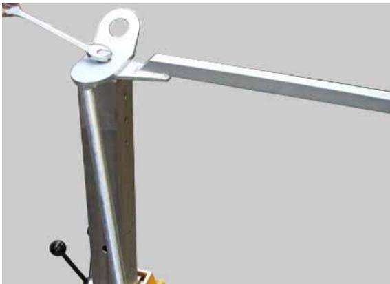
Bild 3.10 Distanzrohr zwischen rechter Bohrsäule und Abstützung schrauben
