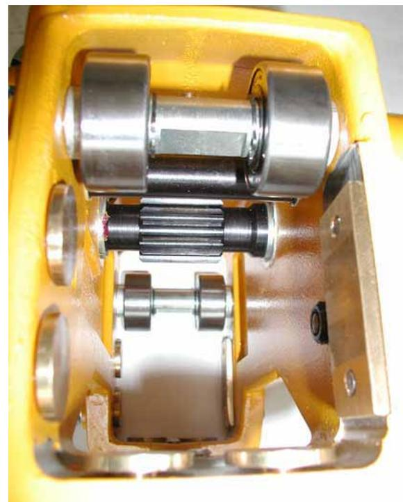
Bild 7.11 Lager am demontierten Führungsschlitten
