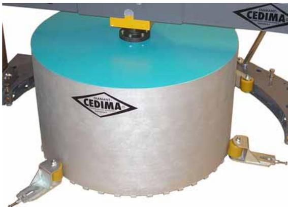
Bild 3.37 Andruckrollen an der Bohrkronen
