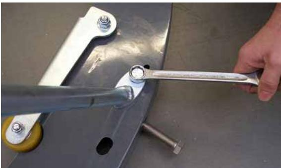
Bild 3.9 Rechte Bohrsäulen-Stütze an Dübelfuß schrauben
