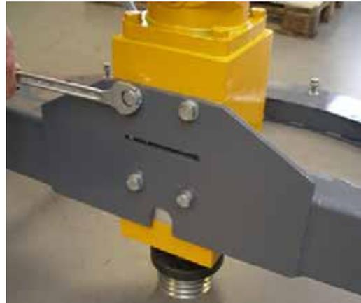
Bild 3.27 BSP•4 mit HM•315 an Bohrtraverse schrauben
