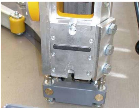
Bild 3.20 Anbauplatte am rechten Führungsschlitten montiert
