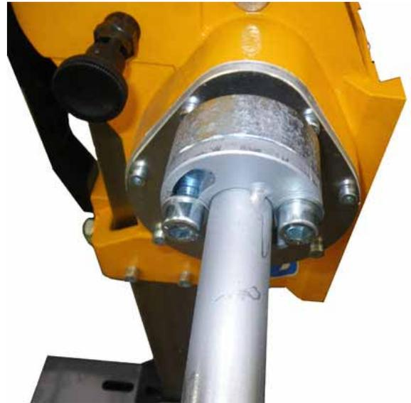
Bild 3.16 Vorschub-Verbindungswelle am rechten Führungsschlitten montiert
