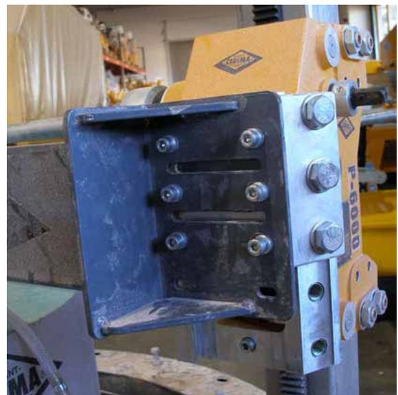
Bild 3.25 Anbauplatten, Bohrtraverse in hoher Position montiert
