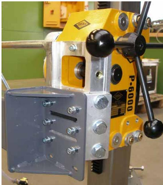
Bild 3.24 Anbauplatten, Bohrtraverse in tiefer Position montiert
