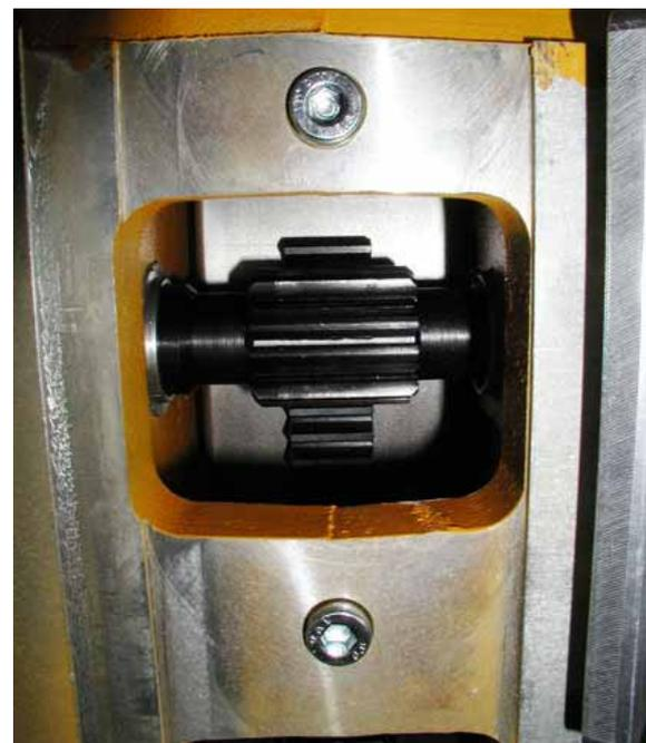
Bild 7.2 Führungsschlitten-Ritzelwelle greift in Bohrsäulen-Zahnstange
