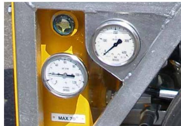
Bild 3.47 HAG•12.10, im Uhrzeigersinn von unten, Hydrauliköl- Thermometer, -Schauglas, -Druckanzeiger
